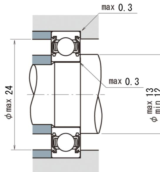
比例尺ではない。面取寸法はラジアル方向、アキシル方向双方の最小許容寸法を表す。
